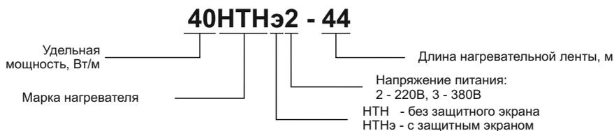
**\*Температура поверхности нагревателя не должна превышать максимальной температуры, которую поддерживают его конструктивные материалы. Это обеспечивается путем ограничения температуры ленты при помощи терморегулятора.**
